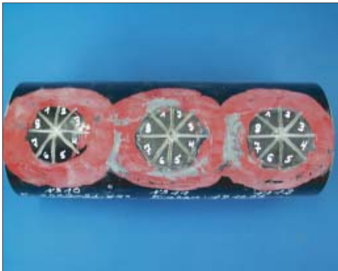
Bild 8: DENSOLID FK2: Kathodische Enthaftung nach DIN 30671
