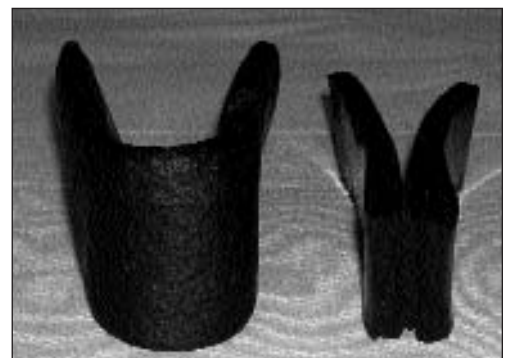
Abbildung 8: Fugenbandproben nach dem „Knick- test“ im Vergleich. Links ein dehnfähiges Produkt, rechts ein hartes Material, das beim Biegen sofort bricht
